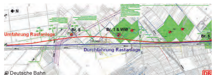
Im Interesse des Trinkwasserschutzes entschieden sich die Verantwortlichen dank Hessenwasser für eine Durchfahrungsvariante.
